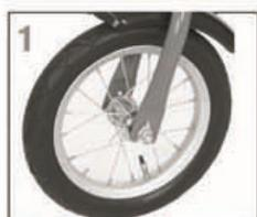
1. Stecken Sie das Vorderrad in die Gabel und ziehen Sie die Muttern fest. Achten Sie darauf, dass sich die Haken der Sicherungsbleche in den dafür vorgesehenen Löchern in der Gabel befinden.
