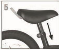
5. Stecken Sie den Sattel in das Sattelrohr. Beachten Sie, dass Sie die maximale Sitzhöhe nicht überschreiten, indem Sie die Sattelstütze nicht weiter als die Markierung „MAX“ herausziehen, da die Überschreitung der maximalen Sitzeinstellung zu ernsthaften Verletzungen führen kann.
